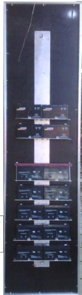
Rückwand des 100W Routers mit voll ausgebauter Ladekapazität. In die Batteriefächer passen insgesamt 14 Batterien mit einer Ladekapazität von 168Ah. Durch das hohe Gewicht der Bleibatterien sollten die Batterien erst nach der Montage der Rückwand eingebaut werden.
